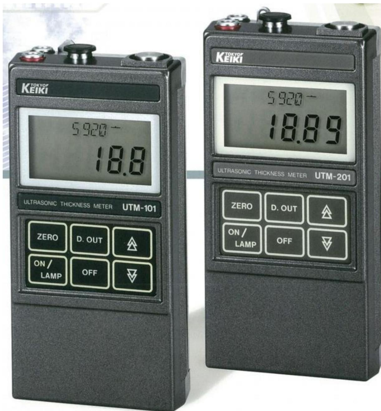
UTM 101 – карманный ультразвуковой толщиномер, характеризующийся небольшими размерами, высокой точностью измерения и наличием встроенных таблиц материалов и метрических единиц. UTM 101 может быть снабжен специальным датчиком 5C3X8NDT-19, который позволяет проводить измерения на изогнутых поверхностях или поверхностях покрытых ржавчиной.
