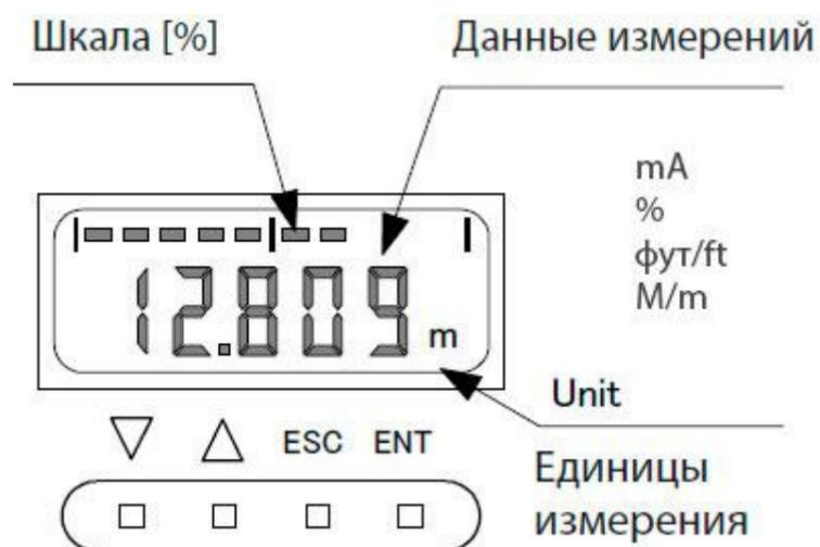
В приборе MRG-10 применяется 2-проводная система. Это значит, что и сигнал и электропитание идут по одним и тем же проводам. MRG-10 сертифицирован как искробезопасный прибор. Следовательно, если вы намерены использовать его в опасных зонах, необходимо использовать также искробезопасный изолятор.
